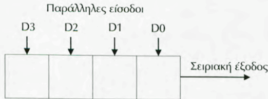
Σχήμα 7.3.8 Σχηματικό διάγραμμα καταχωρητή ολίσθησης PISO 4-bits
